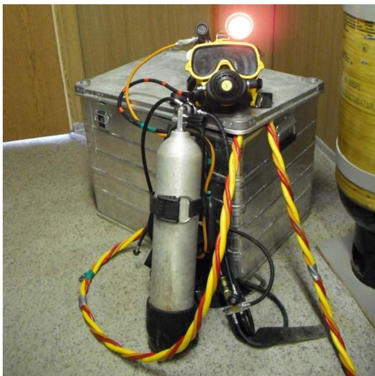
**Фото 3. Ящик для хранения 3-х компонентной КШС, резервного аппарата и маски EXO-26BR**
