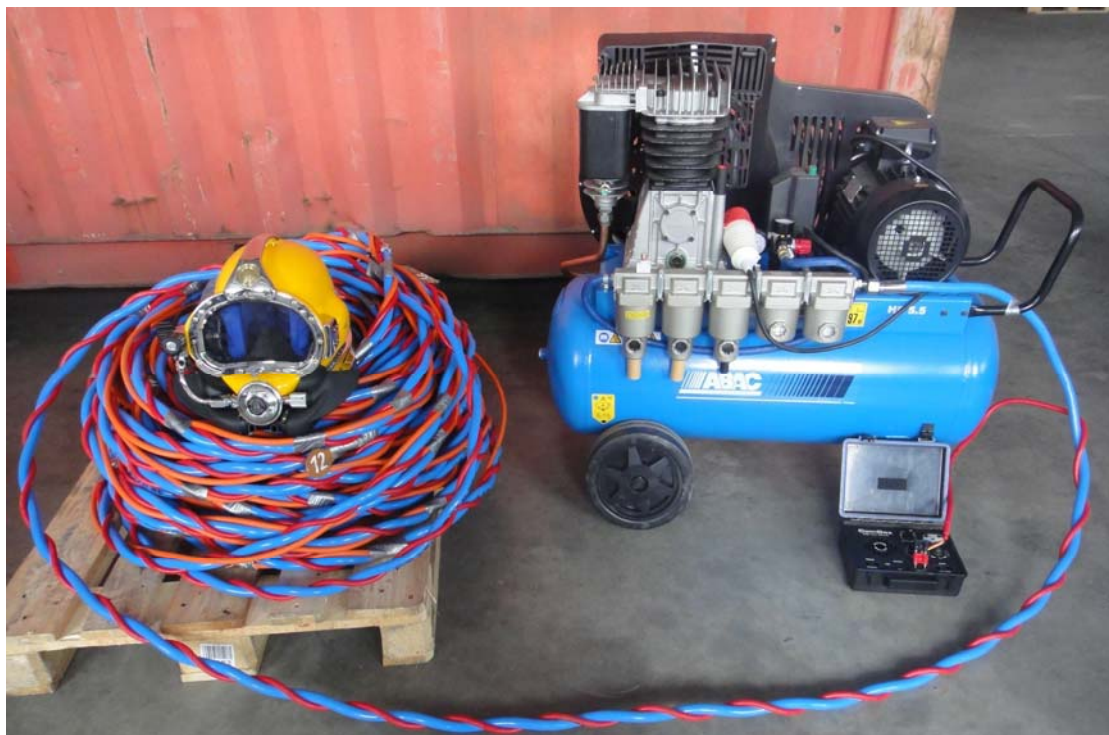
Фото 3. Мобильная водолазная станция в варианте с подачей воздуха от электрической помпы
