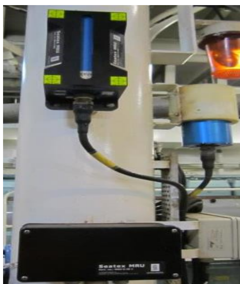
Рисунок Д.10 – Датчик динамических перемещений судна Seatex MRU-5
