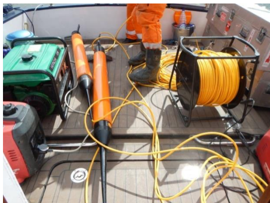
Рисунок Д.17 – Морской магнитометр SeaSPY 1000m
