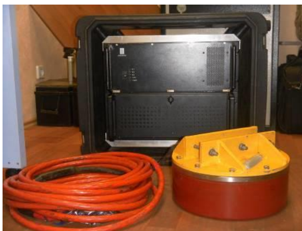
Рисунок Д.6 – АГК на базе МЛЭ Kongsberg EM 3002
