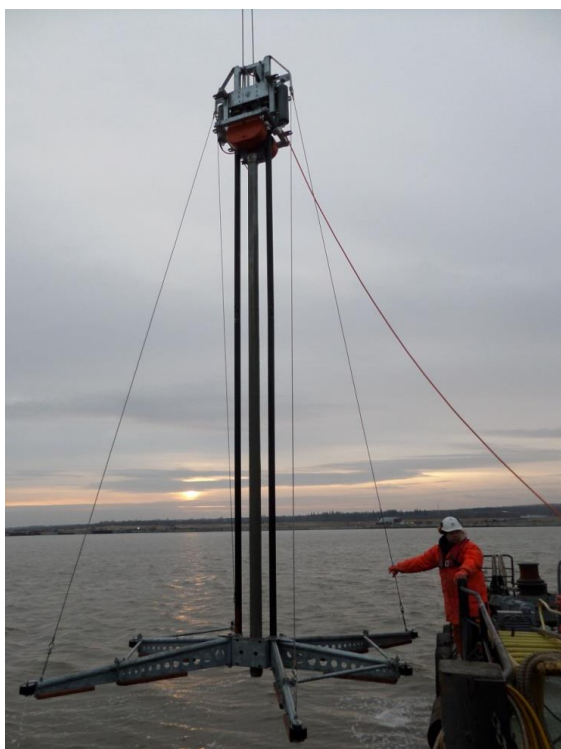
Рисунок Д.14 – Вибропробоотборник GeoCorer 3000 + 6000 (ВПО)
