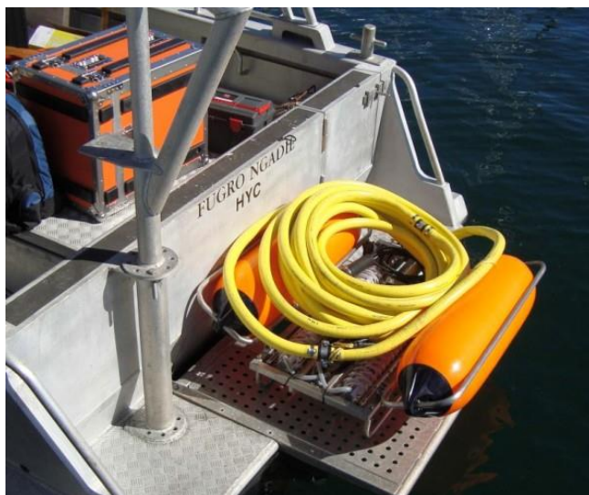
Рисунок Д.15 – Одноканальный комплекс НСП GeoSource 200LW
